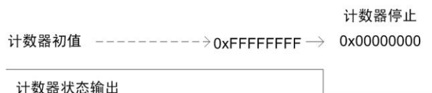
图 4.2 工作方式 0 递增计数模式下计数值变化方式
