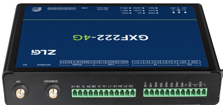
图 3.2 GXF222-4G 工业数采边缘网关底面接口图
