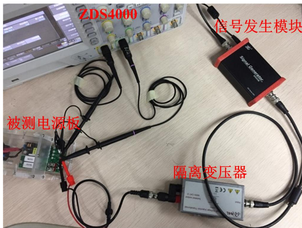
图 2.2 ZDS4000 同步测试实物连接
