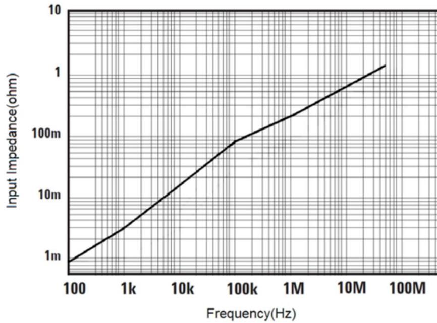
图 5 ZCP30 输入阻抗 VS 测量频率
