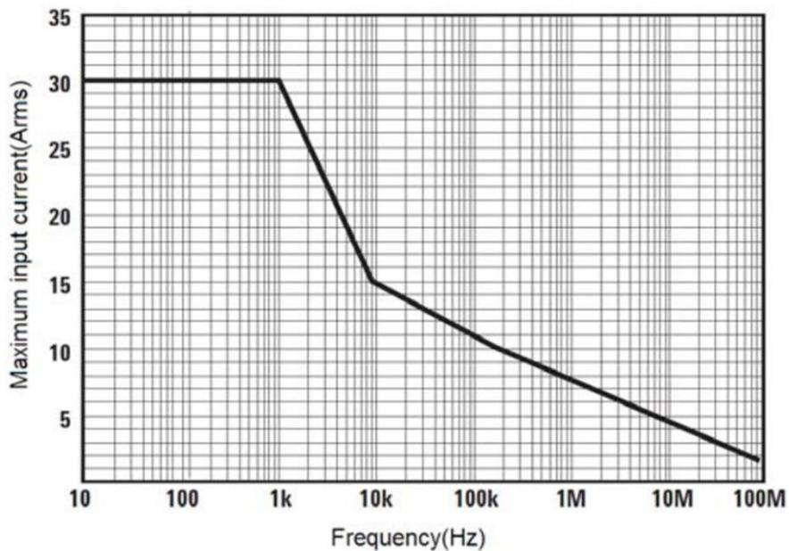
图 4 ZCP30 电流最大值 VS 测量频率
