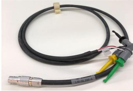
图 1.4 CAN 测量线
