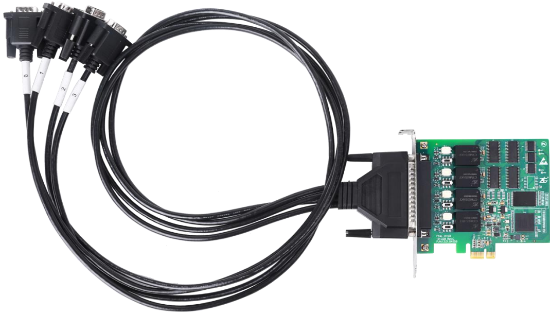
图 2.1 DB37 连接器通过通信线缆转换成 4 个通道的 DB9 接口
