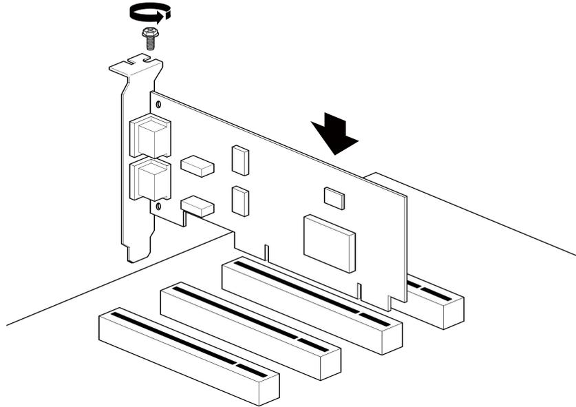
图 2.3 PCI-98XX 系列工业级 CAN 接口卡
