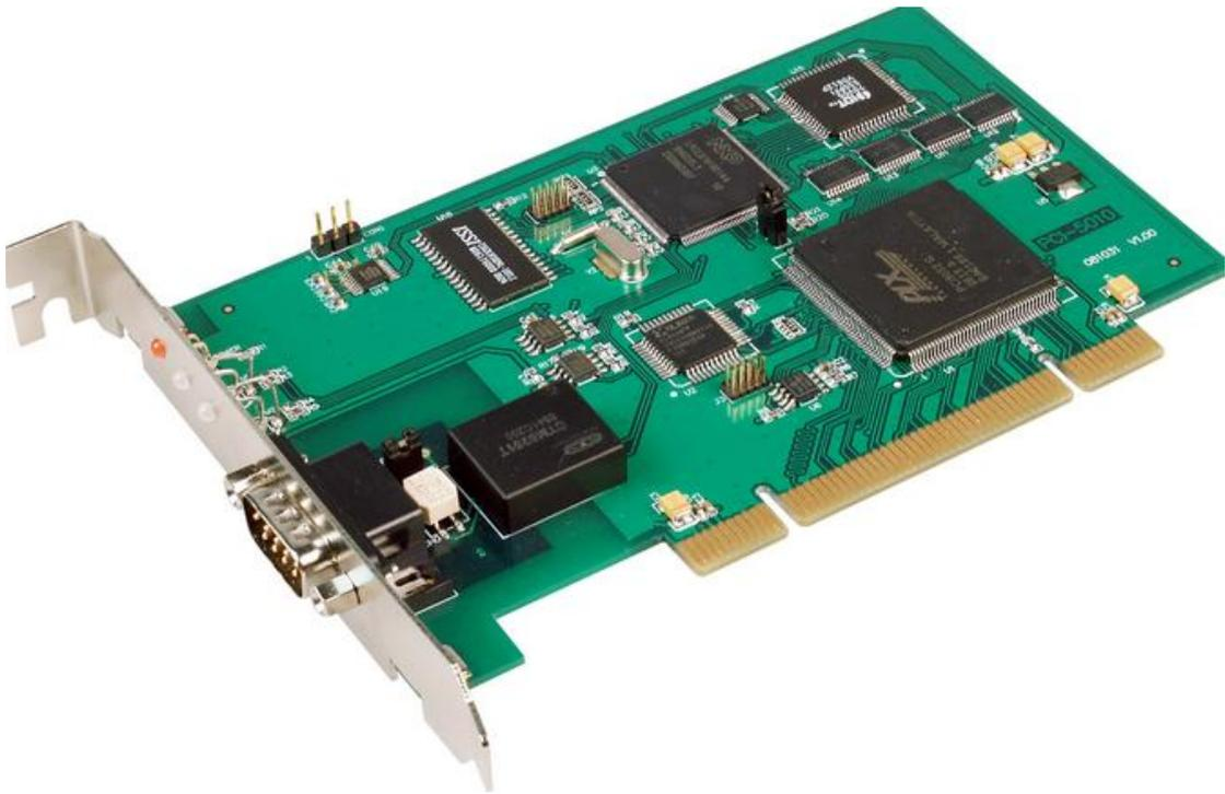
图 1-1 PCI-5010-U 单路 CAN 通讯卡
