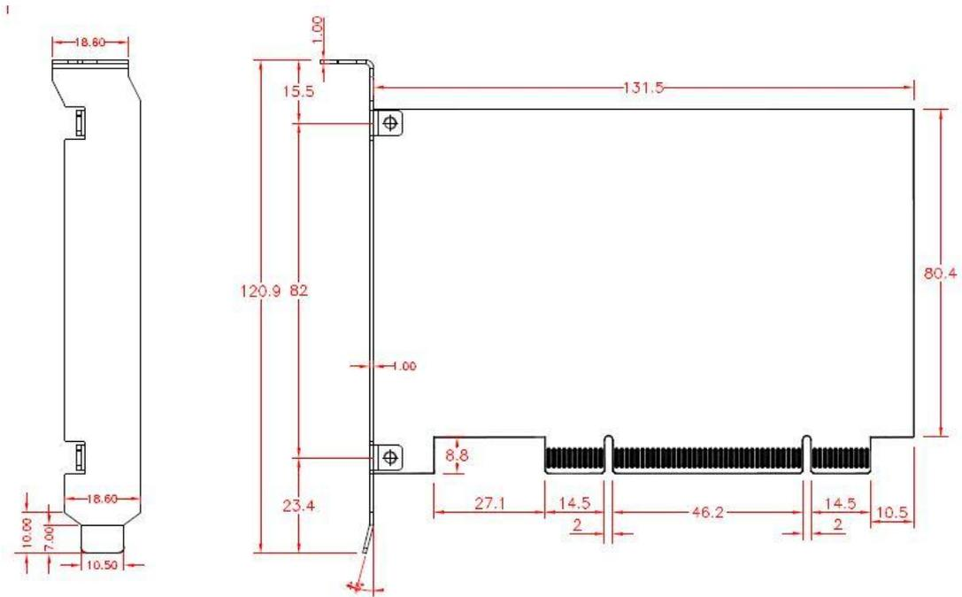
图 1-18 PCI-50X0 通讯卡的机械尺寸
