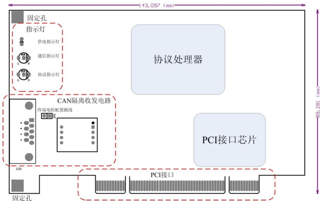
图 1-2 PCI-50X0 通讯卡的硬件框图
