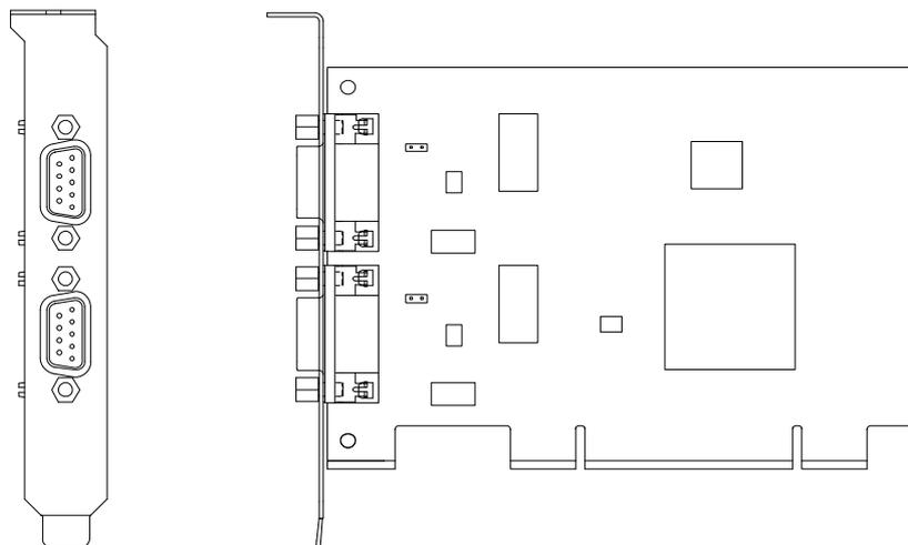
图 1-3 PCI-50X0 通讯卡的 CAN 接口
