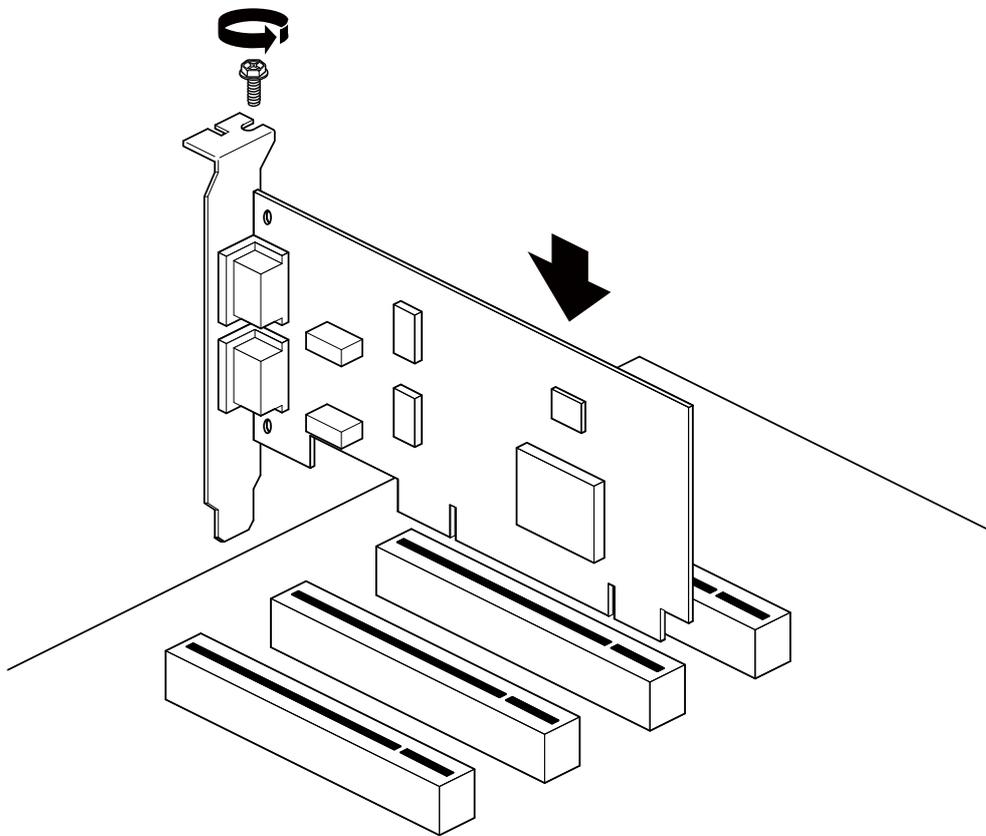
图 1-7 PCI 通讯卡的安装示意图
